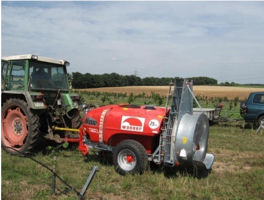
Abbildung 3: Gebläsespritze der Firma Wanner beim Ersteinsatz
