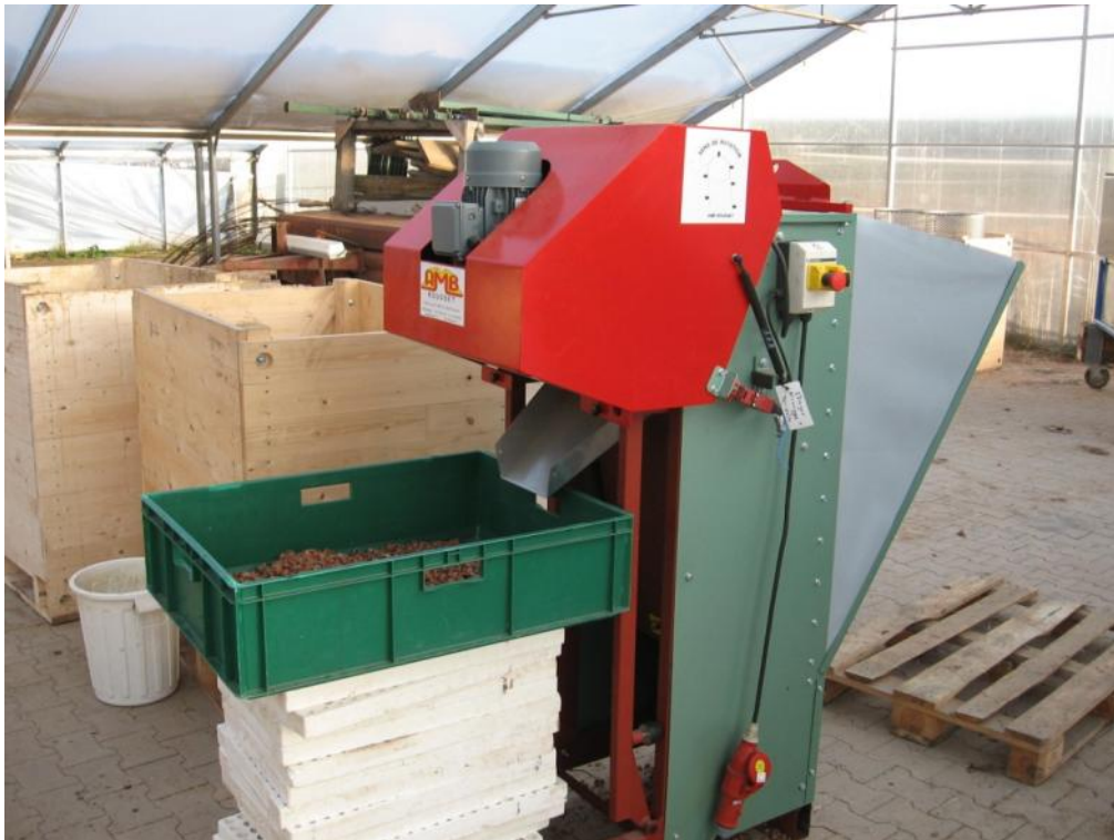
Abbildung 21: Knackmaschine AMB im Einsatz
