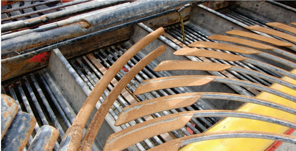
Abb. 44: Elevatorband mit bereits entnommenen Paddeln
