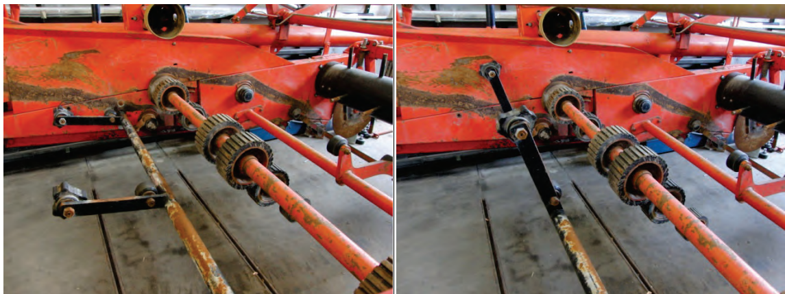
Abb. 10: (links) abgesenkte, (rechts) angestellte Verstellung im 1. Siebband ohne Band
