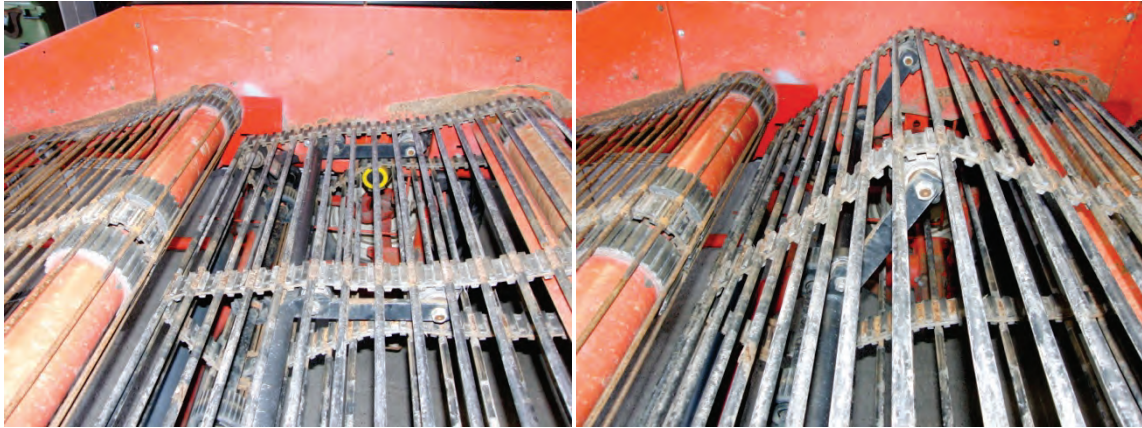
Abb. 16: (links) abgesenkter, (rechts) steil gestellter Abschnitt im 2. Siebband
