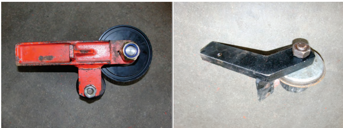
Abb. 21: (links) original, (rechts) abgewinkelter Umlenkrollenhalter im 2. Siebband
