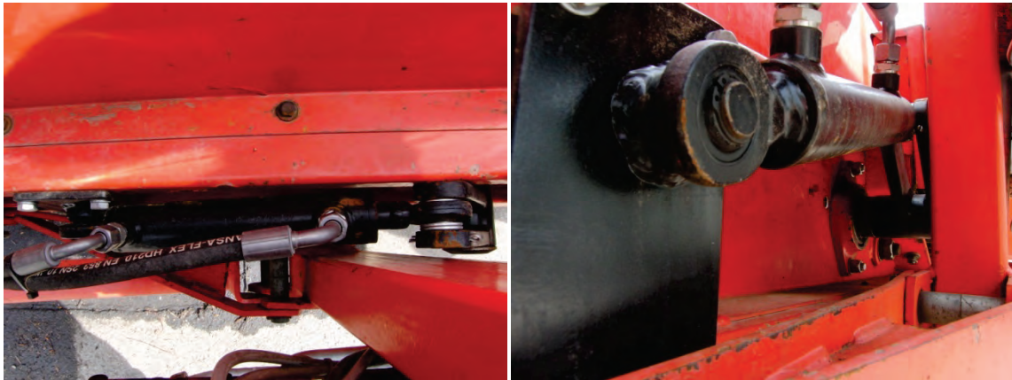
Abb. 11: Hydraulische Neigungswinkelverstellung im 1. Siebband
