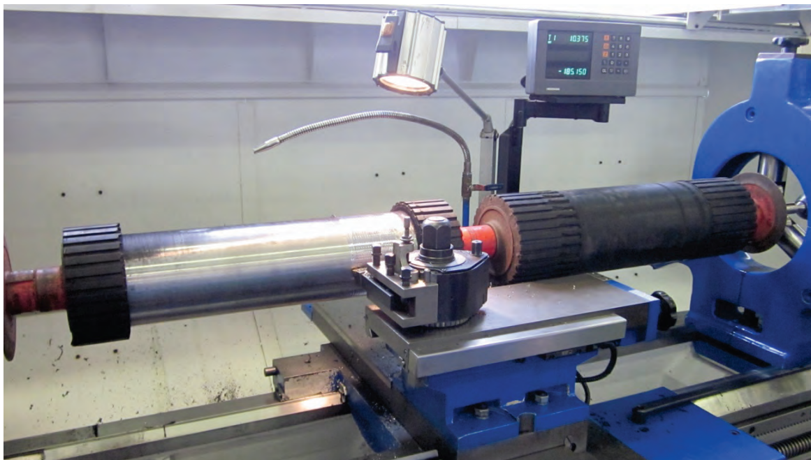
Abb. 15: Abdrehen einer geschlossenen Antriebstrommel
