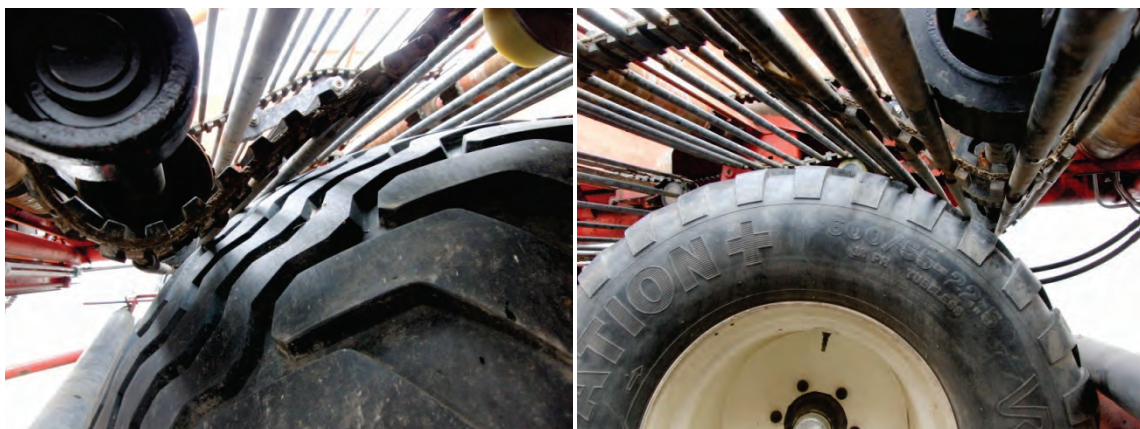
Abb. 25: Kollision des 2. Siebbandes bei eingeschlagenem Reifen und abgesenktem Hangausgleich
