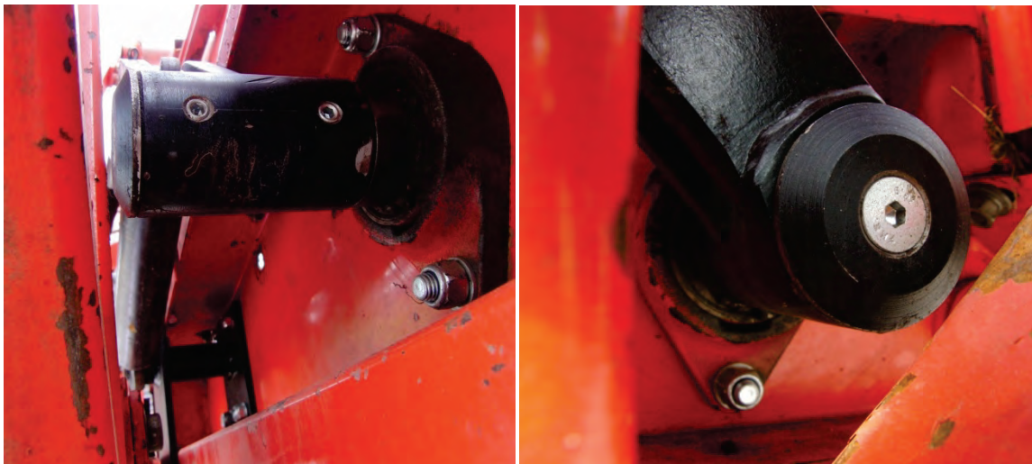
Abb. 12: Abgerundeter Achsenabschluss der Neigungswinkelverstellung im 1. Siebband
