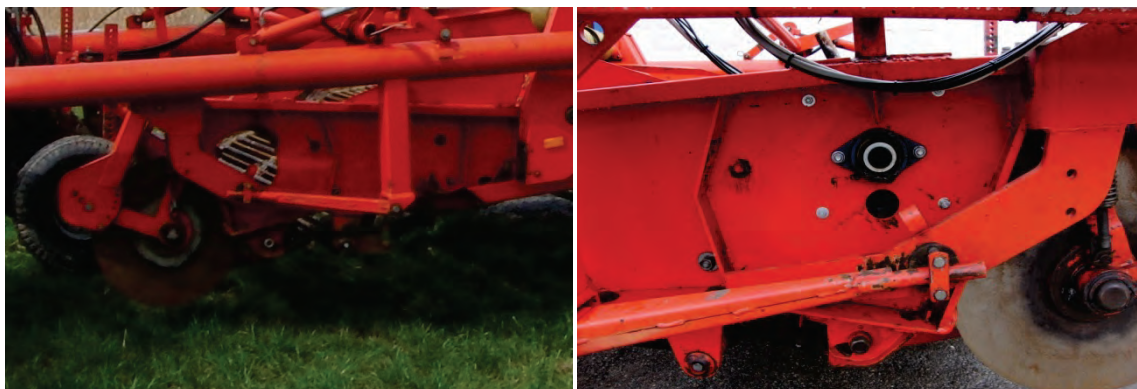
Abb. 7: Aufnahme mit offenem (links) und geschlossenem (rechts) Aufnahmekanal
