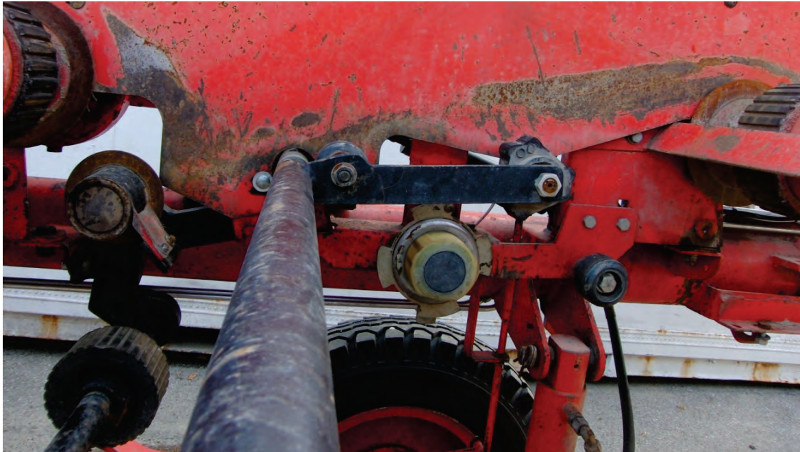
Abb. 20: Position des modifizierten Umlenkrollenhalters im 2. Siebband
