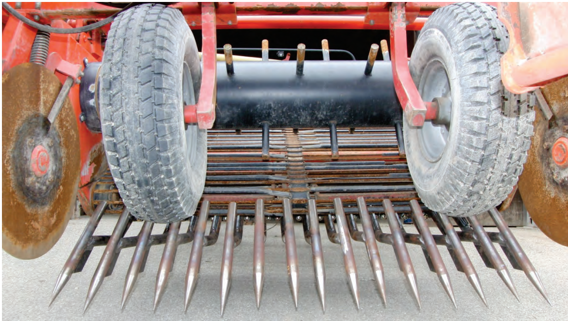
Abb. 3: speziell für Baldrian modifizierte Möhrenscharen
