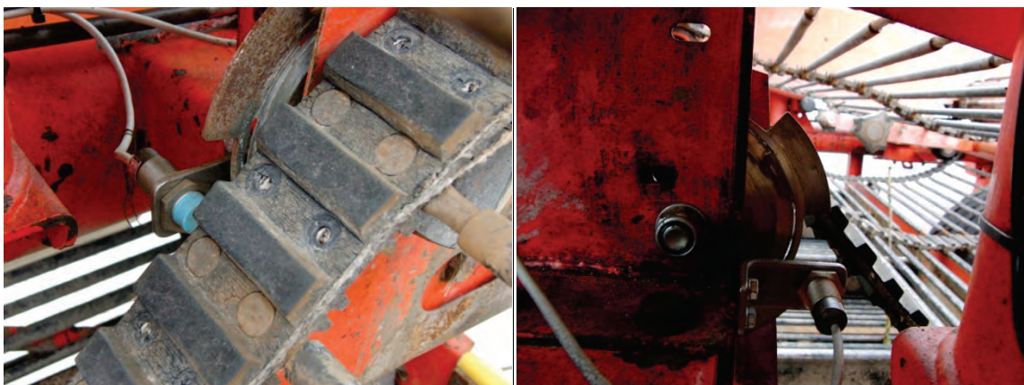
Abb. 53: Spezielle Führungsrolle mit Sensor zur Ermittlung der Bandgeschwindigkeit im dritten Siebband
