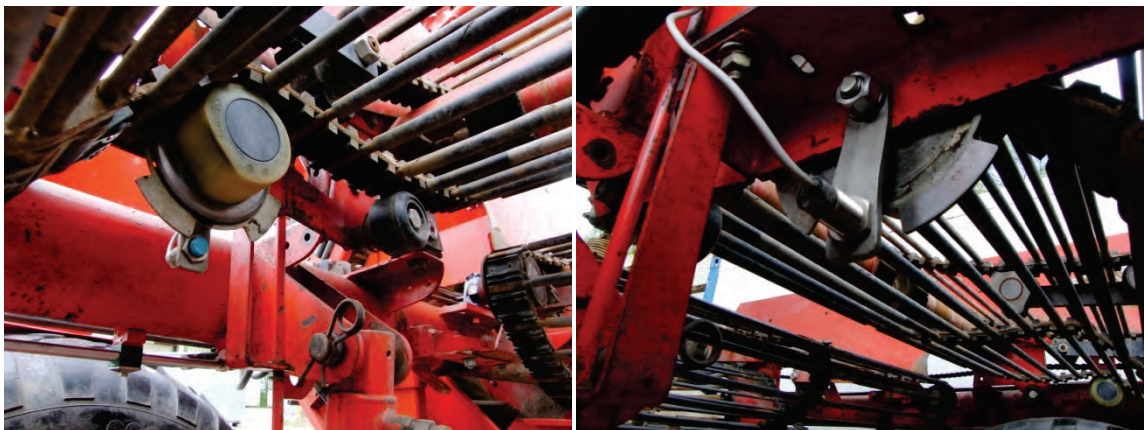
Abb. 52: Spezielle Führungsrolle mit Sensor zur Ermittlung der Bandgeschwindigkeit im zweiten Siebband
