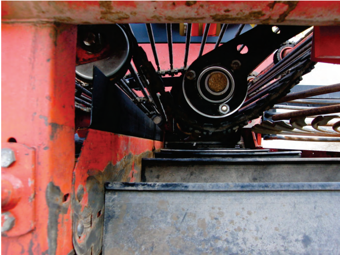
Abb. 45: Erhöhung der Seitenbegrenzung am Elevator
