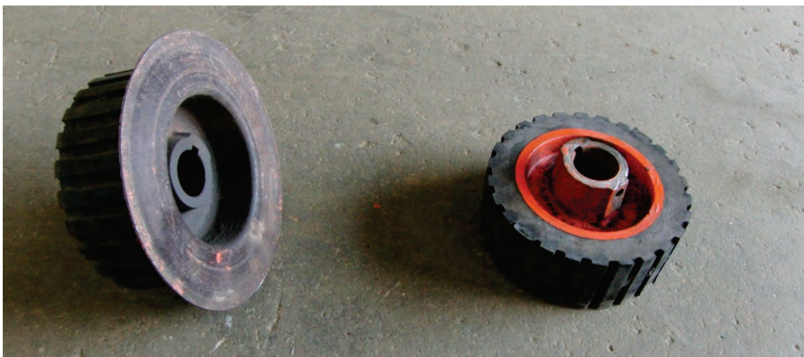
Abb. 27: (links) original, (rechts) abgedrehte Antriebsrolle des Feinkrautelevators
