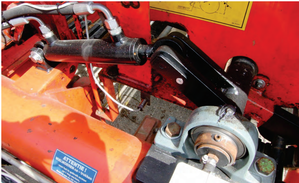
Abb. 18: Hydraulische Neigungswinkelverstellung im 2. Siebband
