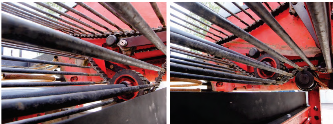
Abb. 34: Kettenspanner im 3. Siebband (links) bei abgesenkter, (rechts) bei steil gestellter Neigungswinkelverstellung
