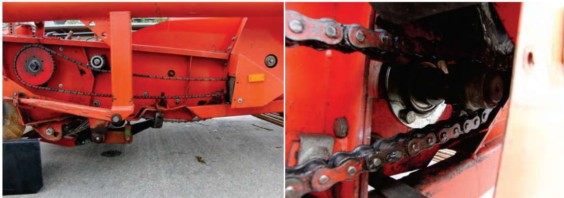
Abb. 8: Reißtrommelantrieb über Gliederkette, (rechts) Antriebsritzel
