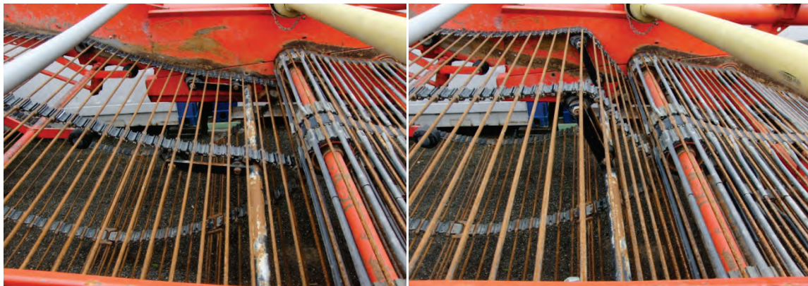
Abb. 9: (links) abgesenkter, (rechts) steil gestellter Abschnitt im 1. Siebband
