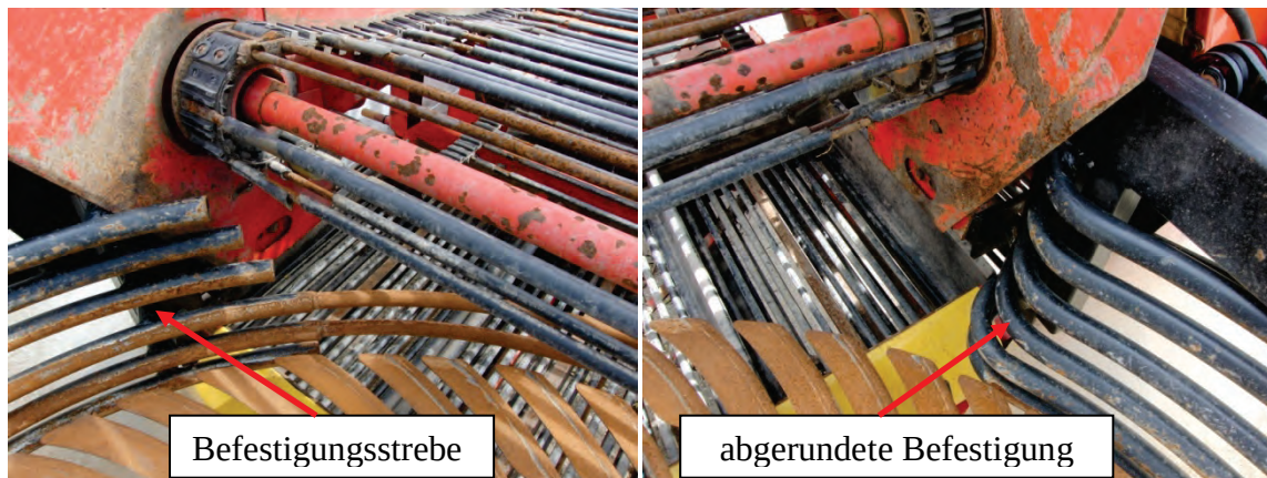
Abb. 38: Gleitrostbefestigung (links vor, rechts nach der Abgabeöffnung)
