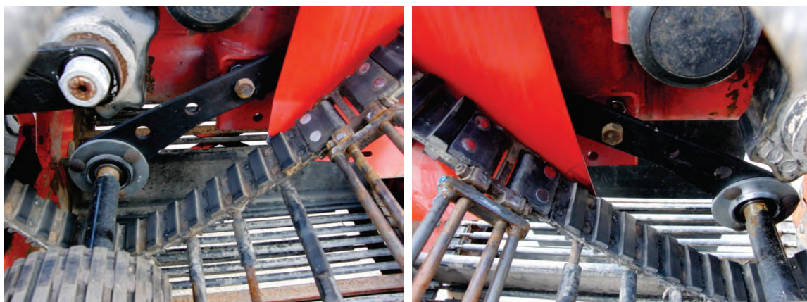
Abb. 35: Befestigung des Kettenspanners im 3. Siebband; (links) linksseitig, (rechts) rechtsseitig
