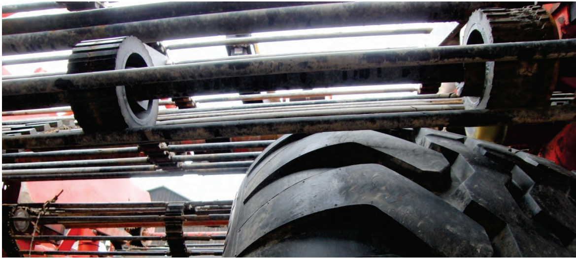
Abb. 26: Positionierung der Rollen im Kettenspanner des 2. Siebbandes
