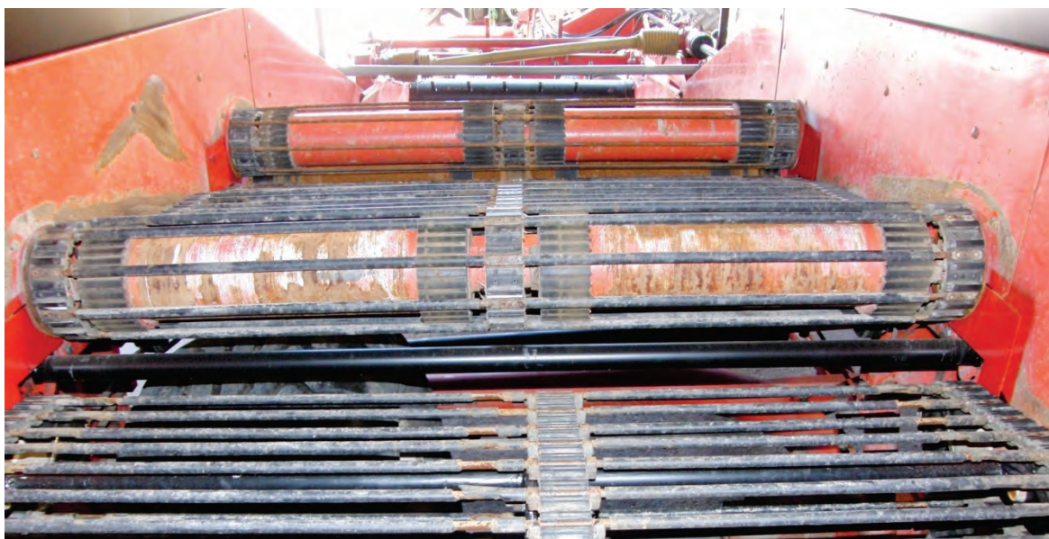
Abb. 14: Optimierte Übergabebereiche zwischen dem ersten, zweiten und dritten Siebband
