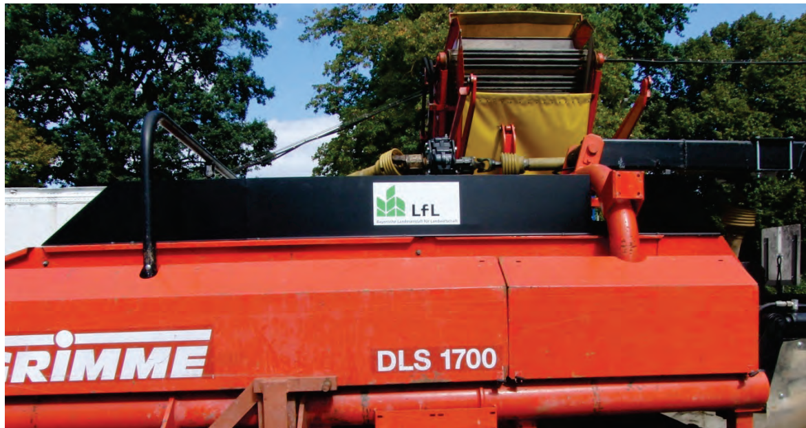
Abb. 57: Erhöhung der Seitenkanalwand
