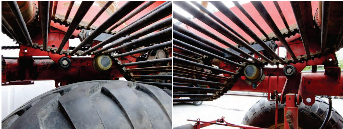
Abb. 22: Führungsrollen unter dem 2. Siebband (links) linksseitig, (rechts) rechtsseitig
