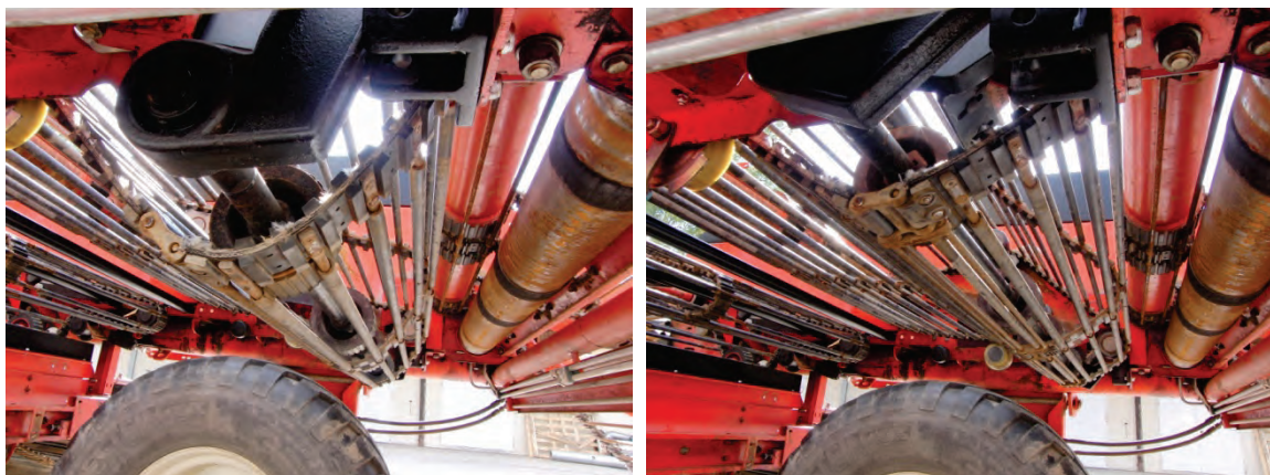
Abb. 23: Kettenspanner im 2. Siebband (links) bei abgesenkter, (rechts) bei steil gestellter Neigungswinkelverstellung
