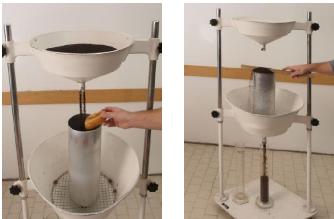
Abb. 5: Bestimmung des Backvolumens anhand der Verdrängung von Rapssamen
