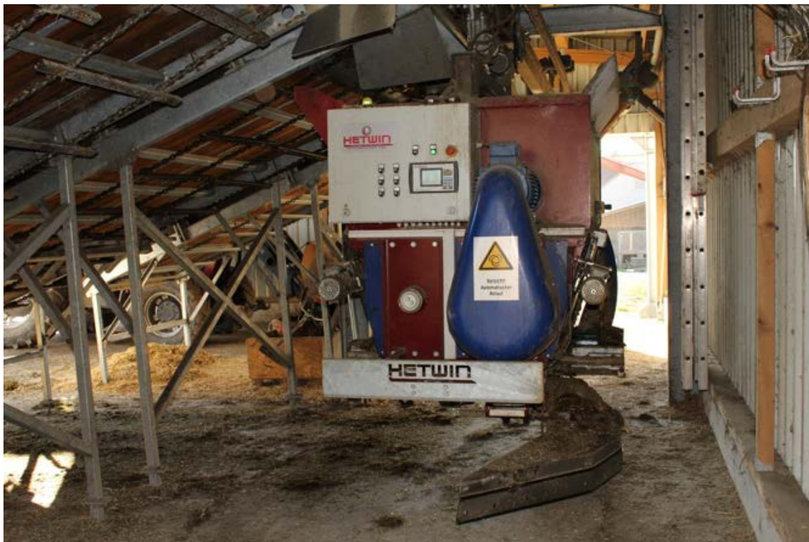
Abb. 2: Automatisches Fütterungssystem bei der Befüllung
