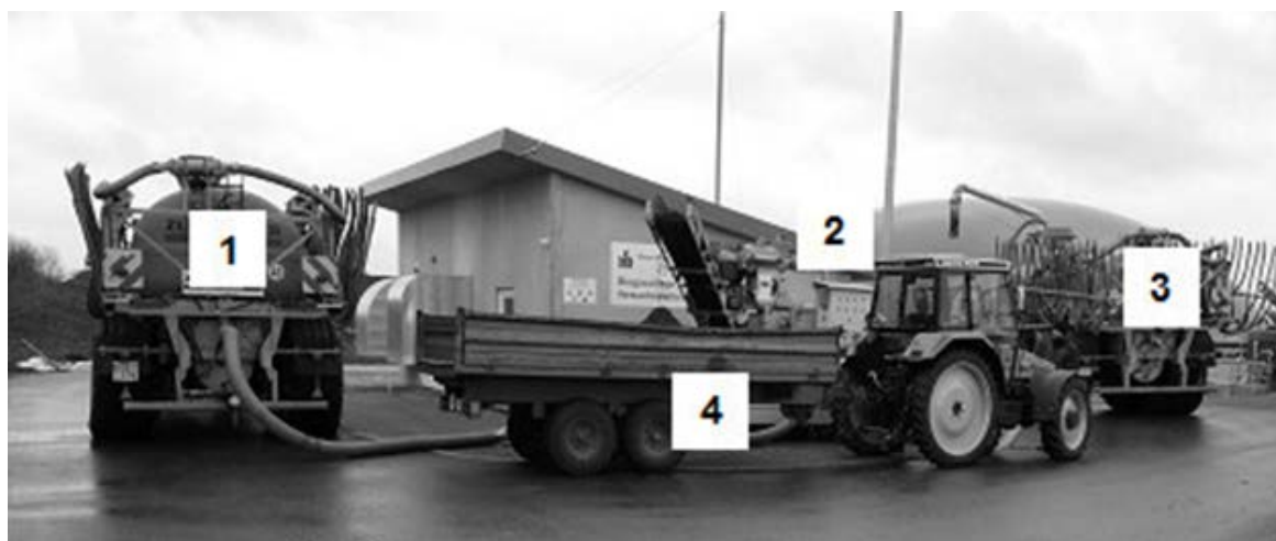
Abb. 2: Versuchsaufbau zur Massenbilanzierung sowie zur Erfassung der Verfahrenskennwerte bei der Wirtschaftsdüngeraufbereitung mit einem Pressschneckenseparator
