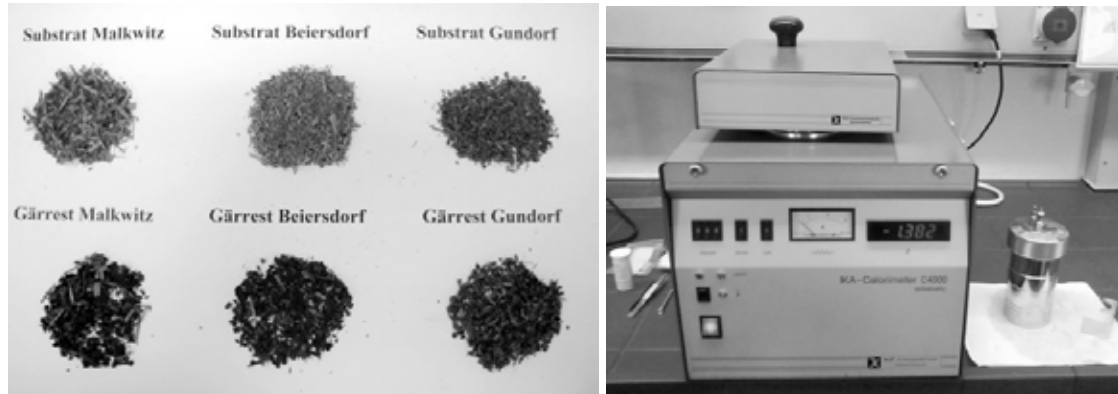
Abb. 2: Substrat- und Gärrestproben für die kalorimetrische Messung (links) und Bombenkalorimeter (rechts)
