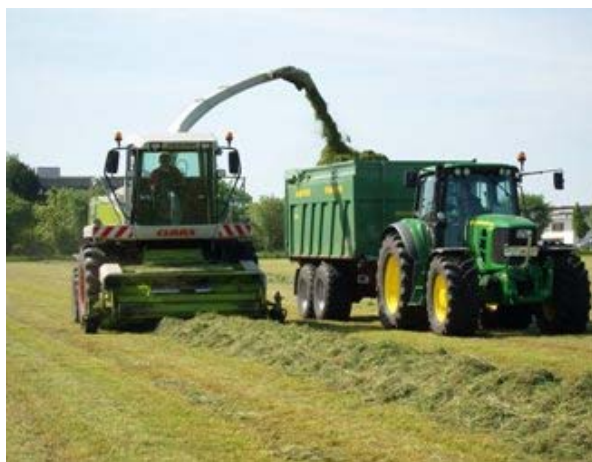
Grasernte mit Online Ertrags- und Feuchtemessung am Feldhäcksler
